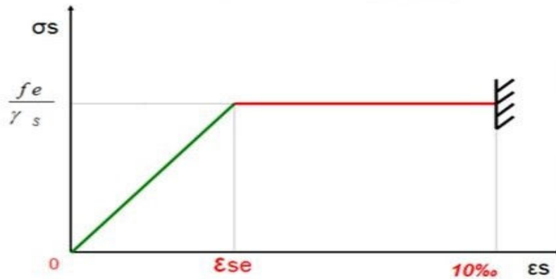
الشكل 2. 5 مخطط التمدد الوحدوي الأعظمي للفولاذ
