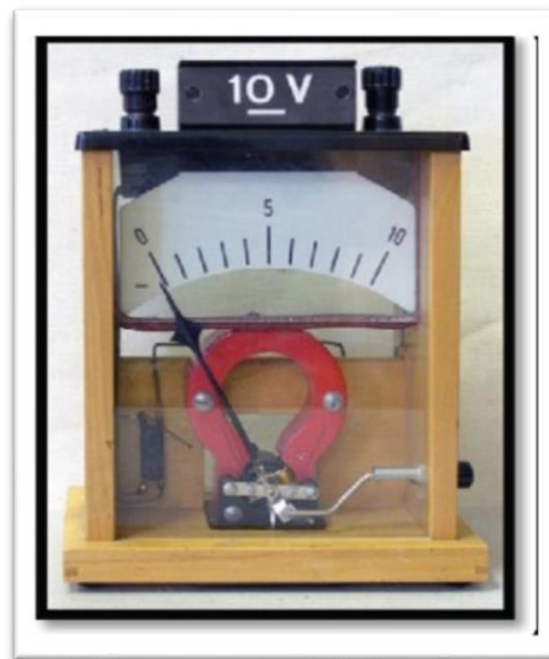
الشكل (1.1): يوضح تركيب ونظرية عمل جهاز القياس ذو الملف المتحرك.
