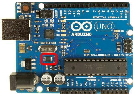
الشكل (12.3): مكان دائرة متكاملة LM358 على لوحة الأردوينو أونو.
