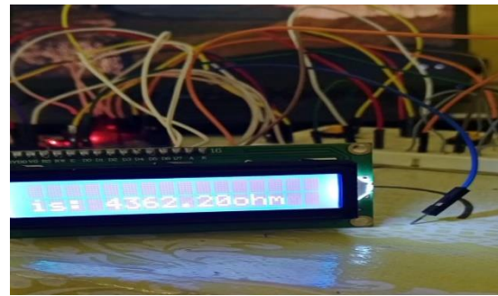
الشكل (29.4): يمثل صورة حقيقية لقياس مقاومتين بقيمتين مختلفتين.
