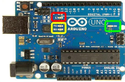
الشكل (10.3): مكان الصمامات الثنائيات الضوئية على لوحة الأردوينو أونو.
