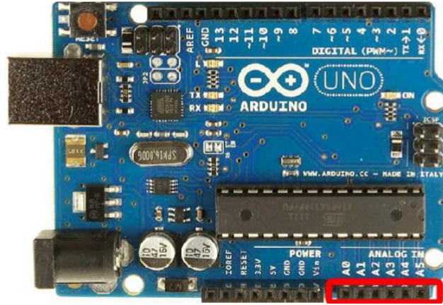
الشكل (15.3): مكان منافذ دخل تماثلية على لوحة الأردوينو أونو (A0, A1, A2, A3, A4, A5).
