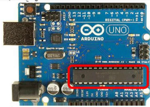
الشكل (7.3): مكان المتحكم AVR ATmega 328 الرئيسي على لوحة الأردوينو أونو.
