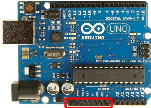
الشكل (14.3): مكان منافذ الاستطاعة تسلسلي على لوحة الأردوينو أونو.
