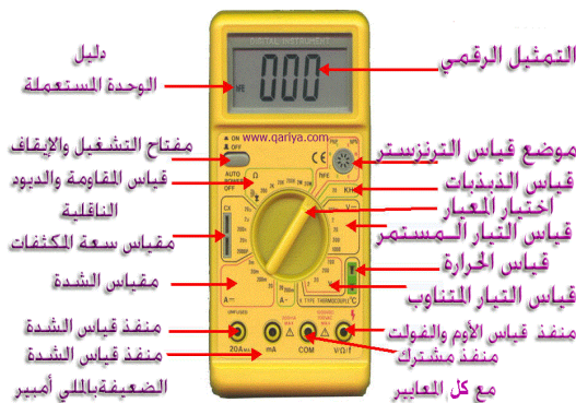
الشكل (7.1): يوضح مكونات جهاز متعدد القياسات الرقمي.
