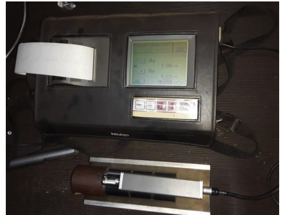
Figure II.10: Méthode de mesure de la rugosité.
