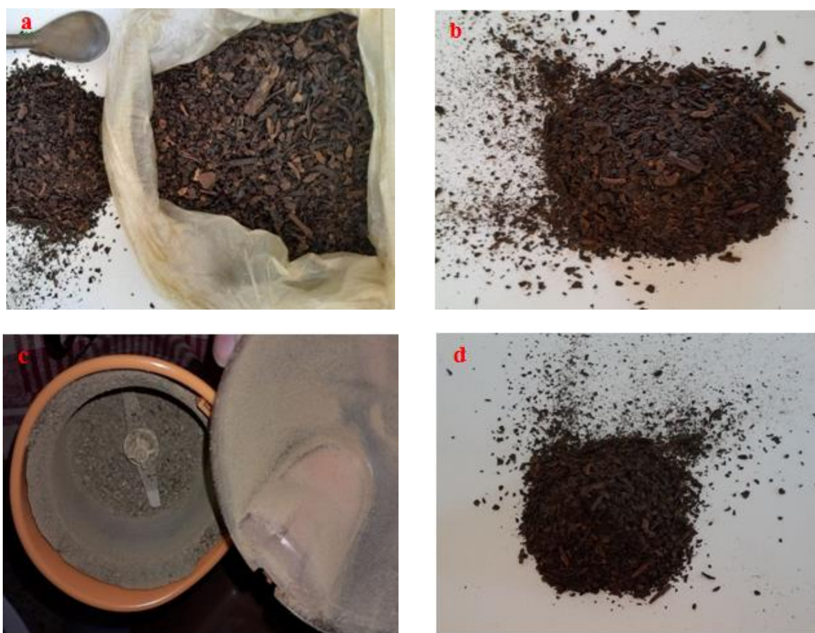
Figure II.10 : Broyage de déchets de concombre calcinés.
