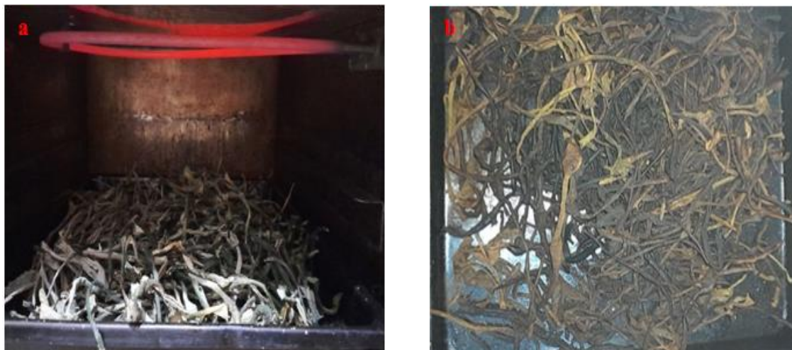
Figure II.9 : a) Four de combustion avec déchets et b) Déchets calcinés.
