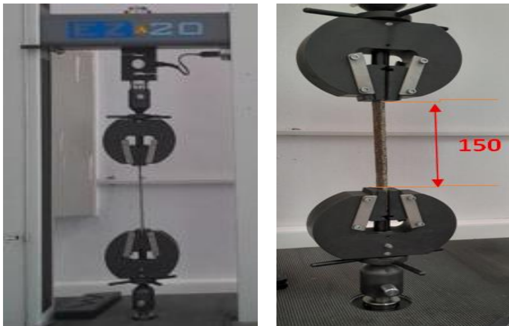
Figure III.1: Montage des éprouvettes sur la machine de traction
