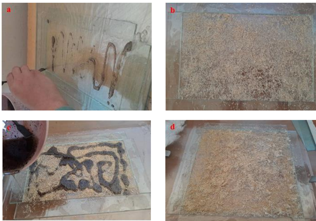
Figure II.14 : Elaboration des plaques composites luffa/époxy/biochar: a) étalage préalable du moule par le mélange résine/biochar, b) dépôt de fibres, c) re-étalage du mélange et d) dépôt de fibres.
