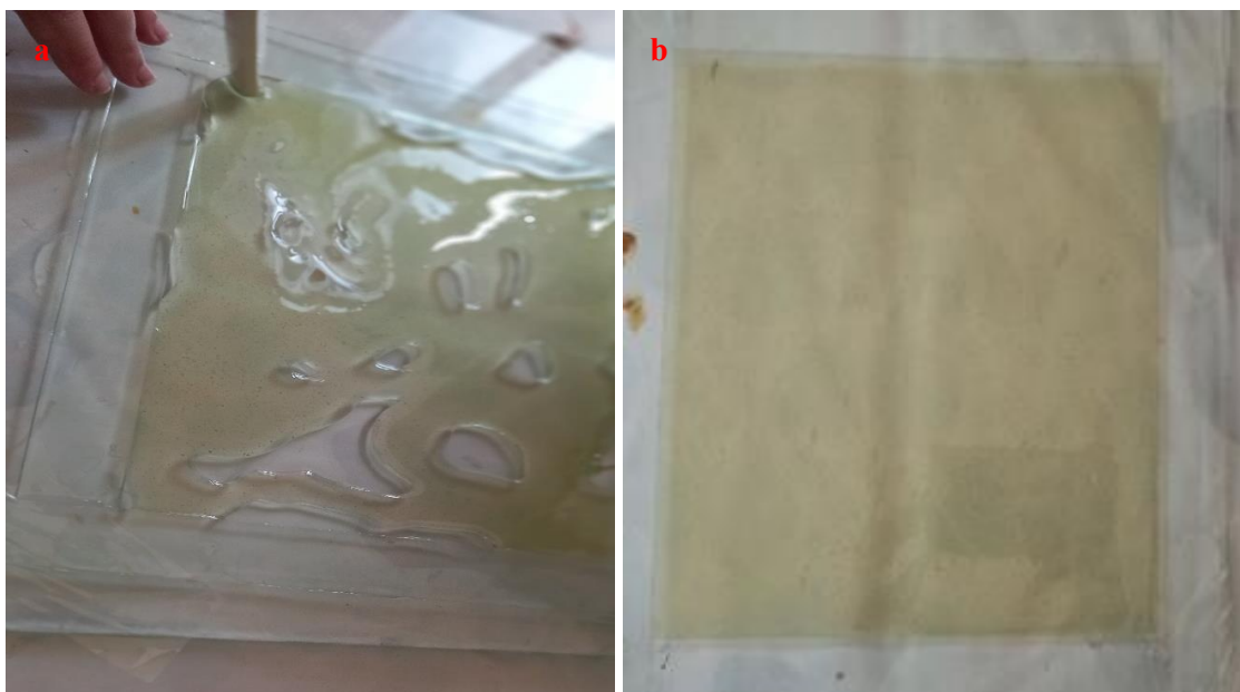
Figure II.16 : Elaboration de la plaque en résine : a) coulée de résine dans le moule Et b) plaque obtenue.
