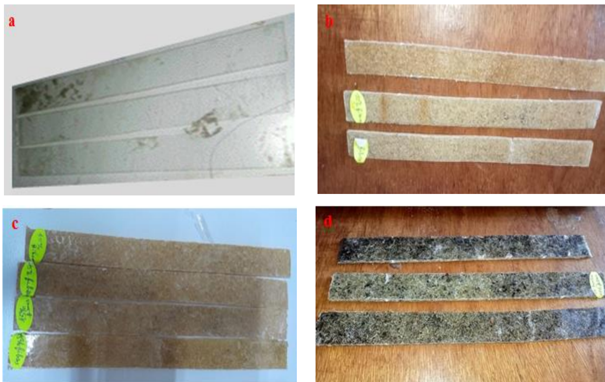
Figure II.18 : Eprouvtes de traction: a) Résine, b) 10% luffa, 15% luffa et 15% luffa et 1% biochar.
