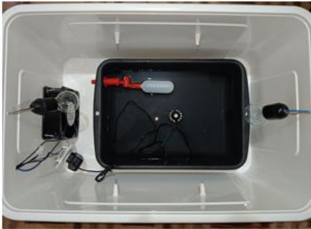
الشكل (6.III): المظهر الداخلي للحاضنة باستعمال النظام القديم ذو الغرفة الواحدة
