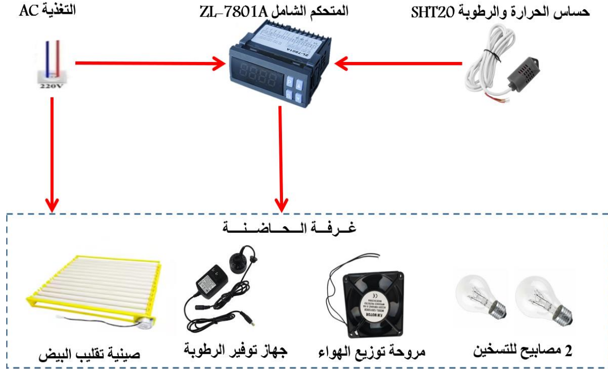
الشكل (3.III): المخطط الصندوقي للنظام التقليدي للحاضنة مع الصور
