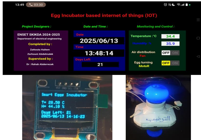
الشكل (20.III): حالة تشغيل المصباح الأزرق عند انخفاض نسبة الرطوبة عن 60%
