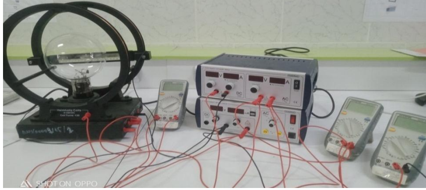
الشكل 1. التركيب التجريبي لحساب الشحنة النوعية للإلكترون
