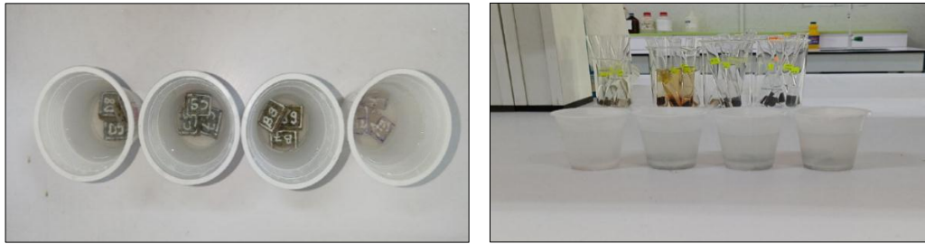
Figure II. 15 : Mesure de l'absorption d'eau.
