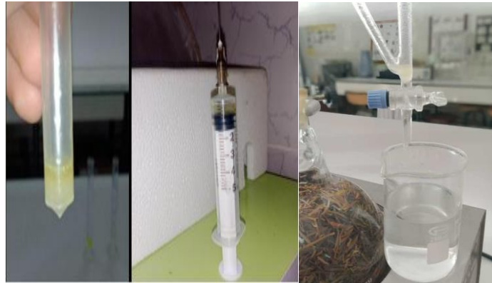
شكل رقم 13 الزيت الأساسي لليسار _ الية التقطير لليمين (صورة شخصية)
