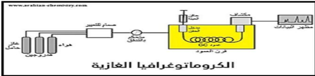
الشكل 48: جهاز الكروماتوغرافيا الغازية ( Bencheikh 2005).
