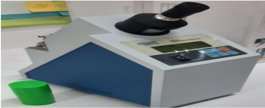
الشكل 54 : جهاز قياس معامل الانكسار (صورة شخصية، 2024)
