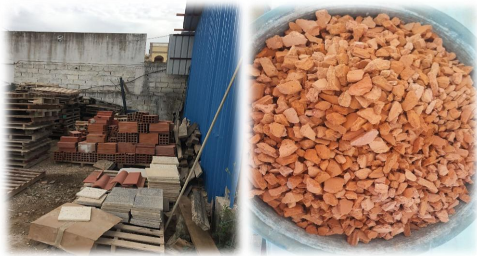
Figure II.4: Les déchets de brique avant et après le concassage
