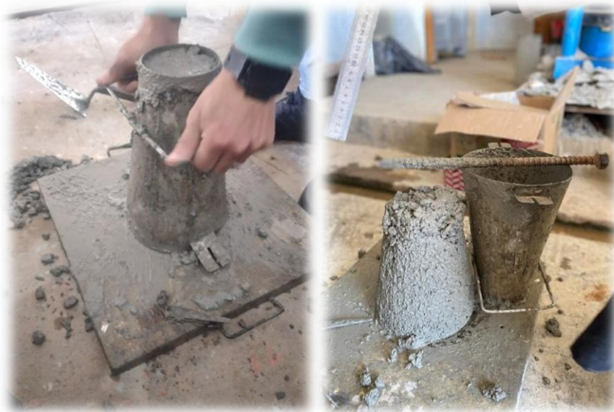
Figure II.20 : L'essai d'affaissement de cône d'abrams
