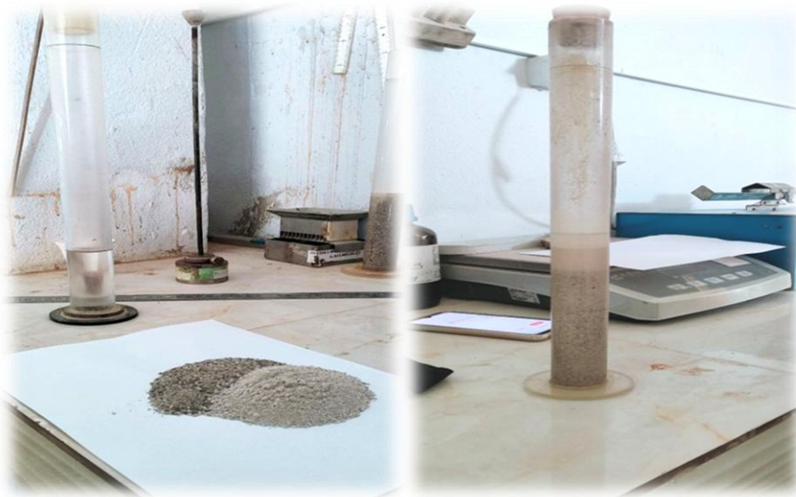
Figure II.12 : Éprouvette de mesure pour l'essai d'équivalent de sable
