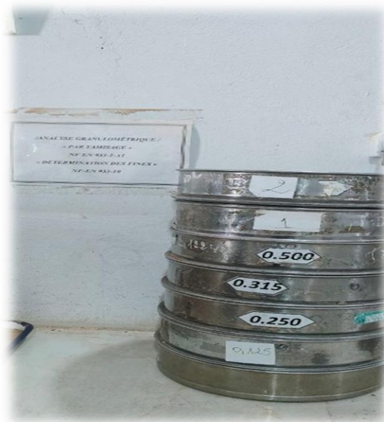
Figure II.8: Analyse granulométrique des granulats
