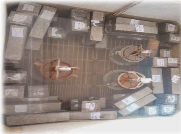
Figure II.21 : Conservation des éprouvettes dans un bain d'eau
