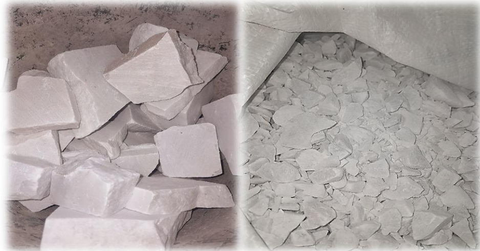
Figure II.5: Les déchets de marbre avant et après le concassage
