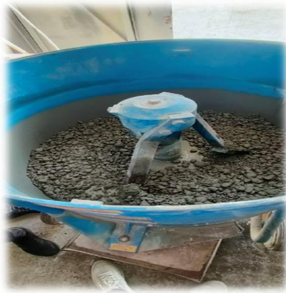
Figure II.18 : Malaxage des différents constituants de béton ordinaire
