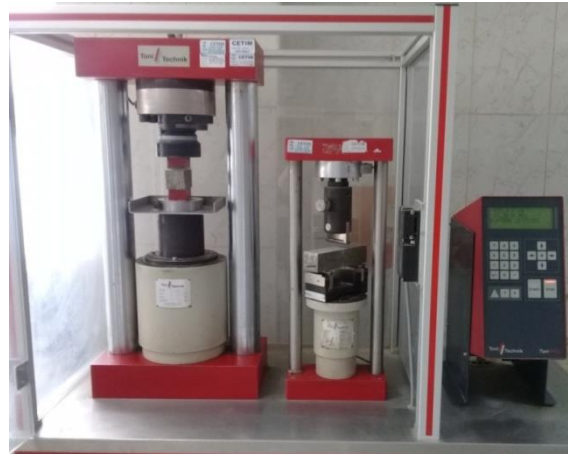
Figure II.10 : Photographie de la machine d'essais de résistance mécanique.
