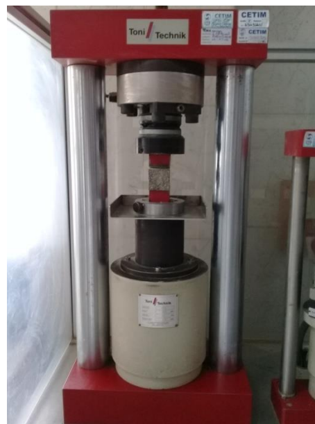
Figure II.14 : Photographie de la partie de l'appareil de la compression.
