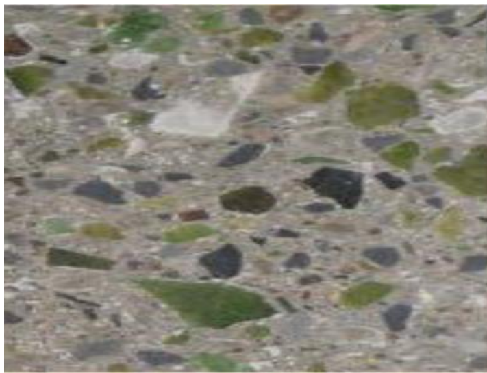
FigI.15: Intégration d'agrégats de verre dans des planchers.
