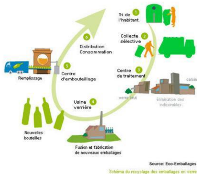
FigI.13: Processus de transformation de déchets de verre.
