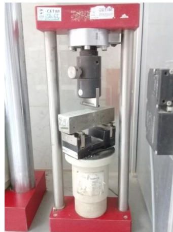
Figure II.12 : Photographie de la partie de l'appareil de la traction par flexion.
