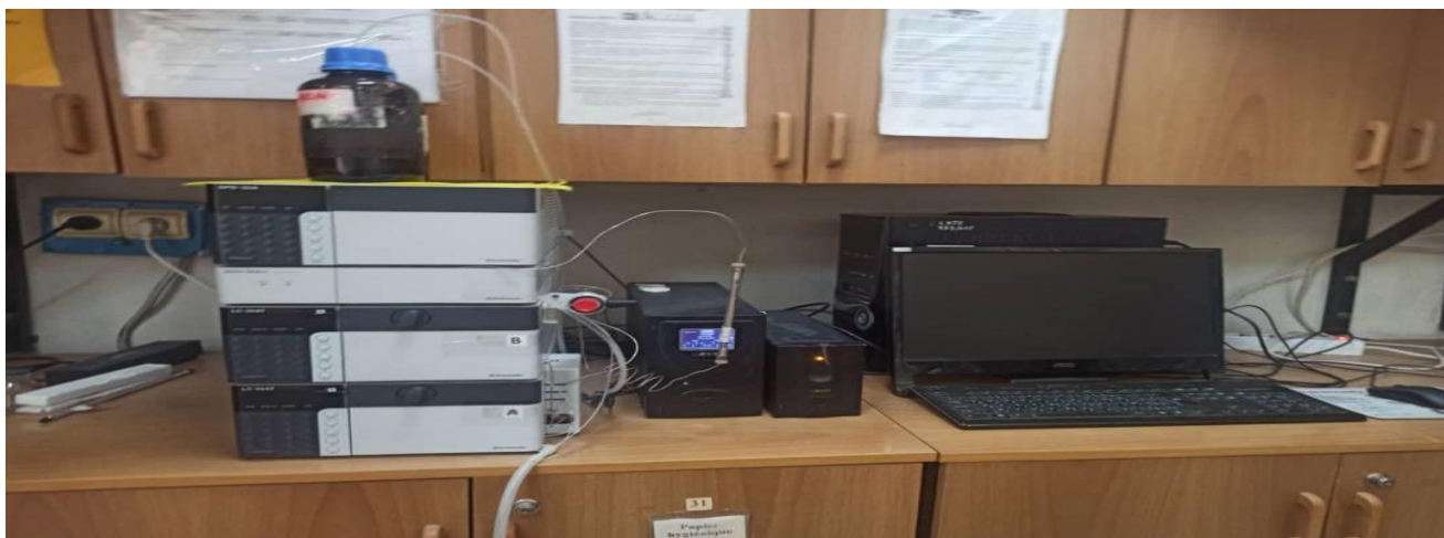
الشكل 5.3: جهاز كروماتوغرافيا السائلة عالية الأداء
