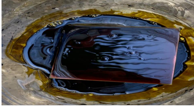
الشكل (37.VI): صورة تبين اللوح النحاسي في محلول حمض كلورات الحديد.
