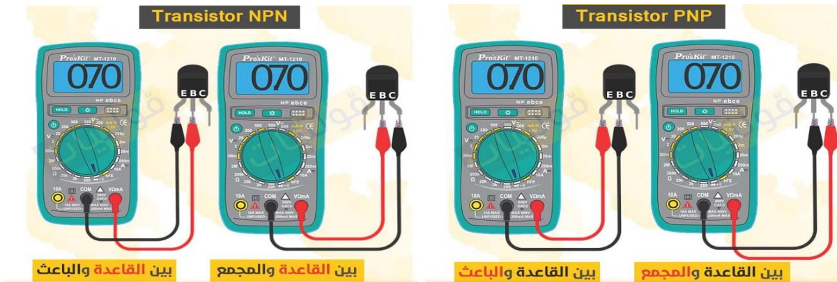
الشكل (1.5): يوضح كيفية فحص الترانزستور بواسطة جهاز متعدد القياسات.
