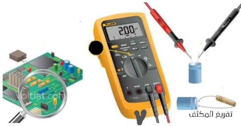
الشكل (1.1): يوضح كيفية فحص المكثفات بواسطة الاوم متر.
